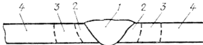
Рисунок 6.1 – Стикове зварне з'єднання
